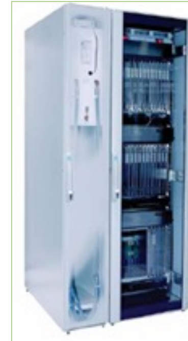
Bsp.: Wassergekühltes Rack mit 4 Blade Center
